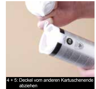
4 + 5: Deckel vom anderen Kartuschenende abziehen
